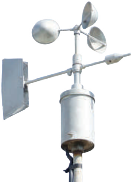
الشكل (4): جهازُ قياسِ سرعةِ الرياحِ واتجاهها.
