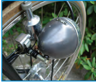
يتصل المولد الكهربائي بعجلة الدراجة
