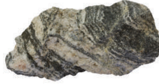
الشكل (23): عند تعرّض الصخر، مثل الغرانيت، لضغط مُوجّه كبير في التحوّل الإقليمي، يعاد ترتيب المعادن المُكوّنة للصخر الأصلي، فيتحوّل إلى نوع جديد من الصخور هو الناييس.
