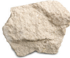
الشكل (17): الصخور الجيرية التي تتكوّن نتيجة ترسّب كربونات الكالسيوم وتصلبها في البحار.
