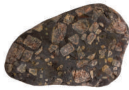
الشكل (8): النسيج السماقي الذي يمتاز بوجود بلورات كبيرة الحجم محاطة ببلورات صغيرة الحجم.
