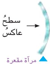
**المراة المقعرة:** يكون السطح العاكس للضوء فيها هو السطح الداخلي يستعملها اطباء الاسنان فضلاً عن استخدامها لتركيز أشعة الشمس في تطبيقات استثمار الطاقة الشمسية.
