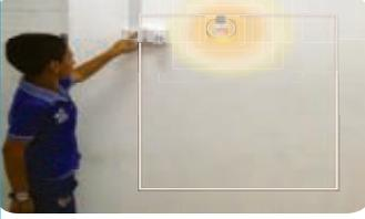
يتحكم المفتاح الكهربائي بسريان التيار في الدارة الكهربائية، في الغرفة فعندما يكون المفتاح الكهربائي مفتوحاً لا يسري التيار الكهربائي بسلك الدارة الكهربائية لذلك لا ينطفئ المصباح الكهربائي، وعندما يكون المفتاح الكهربائي مغلقاً، تكتمل الدارة الكهربائية ويصل التيار الكهربائي إلى المصباح، فيضاء لمصباح الكهربائي كما ألاحظ في الشكل المجاور.
