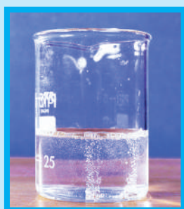
شكل (72) الفلزّات القلوية الأرضية أقلّ تفاعلًا من الفلزّات القلوية وفي هذا الشكل يتفاعل المغنيسيوم ببطء مع الماء الساخن.
