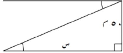
$\frac{50}{s} = \text{ظا } 10^\circ \leftarrow \frac{\text{المقابل}}{\text{المجاور}}$ $s = \frac{50}{\text{ظا } 10^\circ} \approx 283,6$             | ٢ |
