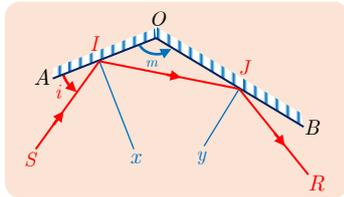
يوضّح الشكل المجاور الظاهرة. نفترض أنّ تمثيل الظاهرة يجري في مستوٍ موجّه. المرآة ممثلة بالشكل  $AOB$ ، وقياس الزاوية بين السطحين هو  $(\vec{OA}, \vec{OB}) = m$ . أما قياس زاوية الورد فهو  $(\vec{IA}, \vec{IS}) = i$ .
