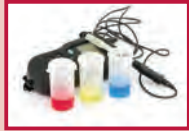
شكل (64) جهاز قياس الرقم الهيدروجيني مع محاليل منظمة لمعايرة الجهاز
