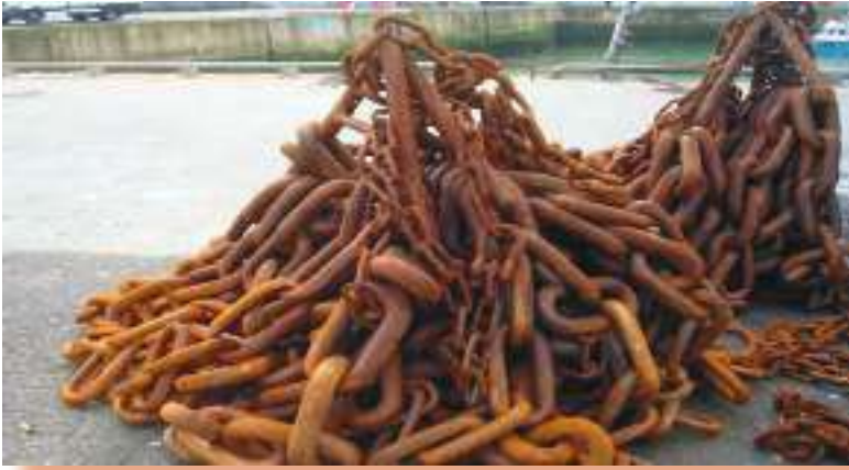
الحديد يصدأ عند تعرضه للهواء الجوي
