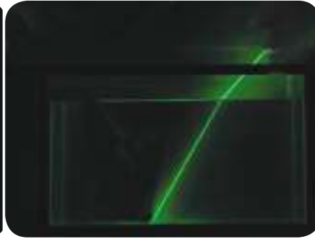
ينكسر الضوء عند انتقاله من الهواء إلى الماء بشكل مائل.
