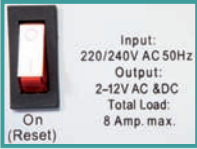
(شكل 55) لوحة وصية لجهاز يظهر فيها قدرته الكهربائية .
