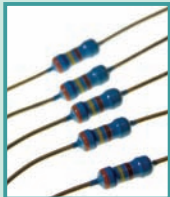
(شكل 49) مقاومات لها ألوان محددة تعطي قيمة المقاومة.
