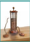
(شكل 43) تألف بطارية فولتا، وهي الخطوة الأولى في صنع البطاريات الجافة التي نستخدمها الآن، من مجموعة أقراص معدنية من النحاس والزنك. يوضع كل قرص من النحاس فوق قرص من الزنك، ويوضع بين كل زوج من هذه الأقراص قطعة من الورق المغمق المشبع بالماء المالح.
