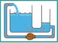
(شكل 45) يستمر تدفق المياه بسبب وجود مضخة تحافظ على الفرق في مستوى الخزّان.
