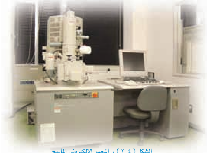
الشكل ( ٢-٤ ) : المجهر الإلكتروني الماسح
