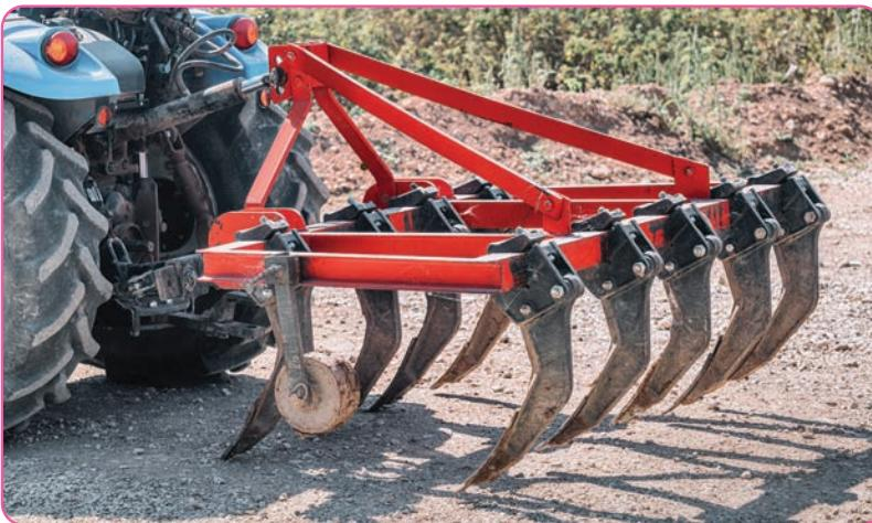
**ب- المحاريث الحفاره:** تستخدم في شق الطبقة السطحية للتربة وتفكيكها، دون قلبها، وتمتاز بسهولة تركيبها على الجرار الزراعي، وتتنج أراضي محروثةً مستويةً وخاليةً من الكتل الترابية الكبيرة.
