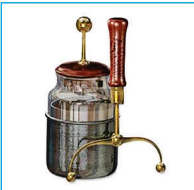
اختراع العالم (بيتر فان) (1746م) أداة لتخزين الشحنات الكهربائيّة في المجال الكهربائي عُرفت بقارورة ليدين، وتطوّرت هذه الأداة بحيث أصبحت أقل حجماً ووزناً، وتُعرف الآن بالمواسع الكهربائي.
