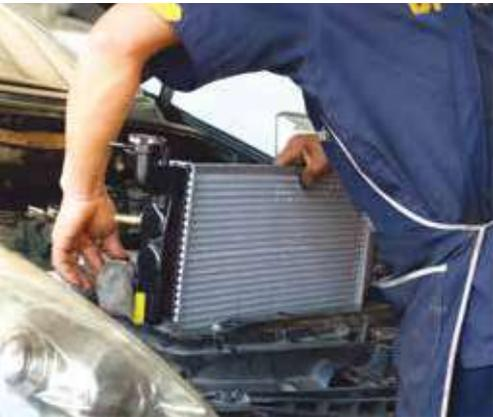
الشكل (5): يُستخدم الرادياتر في أنظمة التبريد؛ للتخلص من الطاقة الناتجة في أجزاء المحرك.
