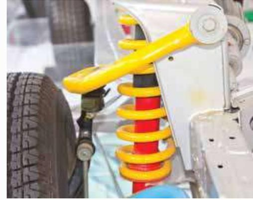
من الناحية التقنية، يُعدّ ممتصّ الصدمات همزة الوصل بين تعليق العجلات وهيكل المركبة؛ ويُثبّت بجانب العجلات على نحو ما يظهر في الشكل المجاور؛ إذ يجري التغلّب على عدم استواء الطريق عن طريق امتصاص الاهتزازات والحدّ منها؛ وذلك عبر تحويل الطاقة الحركية في النوابض إلى طاقة حرارية خلال السائل الهيدروليكي والوسط المحيط.
