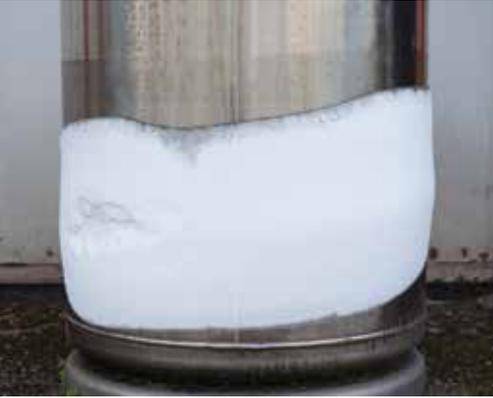
الشكل (15): بذل الغاز المحصور شغلًا على المحيط الخارجي كي يتمدّد، فانخفضت درجة حرارة السائل والأسطوانة الفلزيّة إلى ما دون درجة تجمّد الماء؛ فتجمّد بخار الماء في الهواء الملاصق للأسطوانة ليُشكّل طبقة الجليد.
