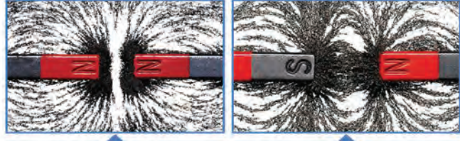
لاحظ ان برادة الحديد تكون على شكل خطوط منحنية مفتوحة عند تقارب قطبين مغناطيسيين متشابهين.
