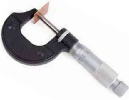
الشكل (3): قياس سُمْكِ صفيحة باستخدام الميكروميتر.
