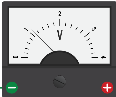
الشكل (9): عدم انطباق المؤشر على أحد تدريجات المقياس.
