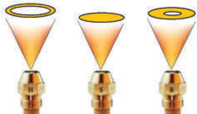
الشكل (10): أشكال مخروط البخ: المصمت المفرغ B، والمصمت S، والمفرغ H.
