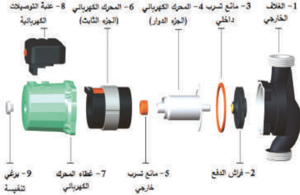
الشكل (2): أجزاء المضخة الطاردة عن المركز.
