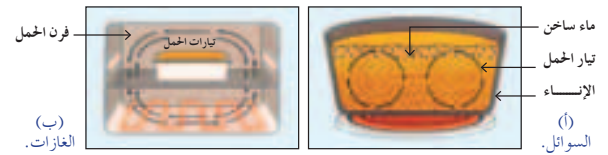
الشكل (٣-٣): طرائق انتقال الحرارة بالحمل في السوائل والغازات.
