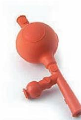
**منفاخ الماصة:** مصنوع من المطاط يستخدم في ملء الماصة بالمحلول (لا تسحب المحلول داخل الماصة باستخدام الفم مباشرة).
