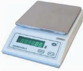
ضع قطعة من الكبريت العمود في البودقة المعينة كتلتها وهي فارغة وأعد قياس كتلة البودقة مع قطعة الكبريت وبهذا نحصل على كتلة قطعة الكبريت من ايجاد الفرق بين كتلة البودقة وهي فارغة وكتلتها مع قطعة الكبريت.
