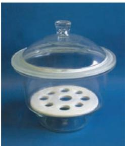
**مجفف:** يستخدم لتجفيف المواد الكيميائية بعد تنقيتها (تخليصها من المذيب)
