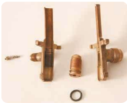
الشكل (2-37): الأجزاء الداخلية لصمام الخدمة.
