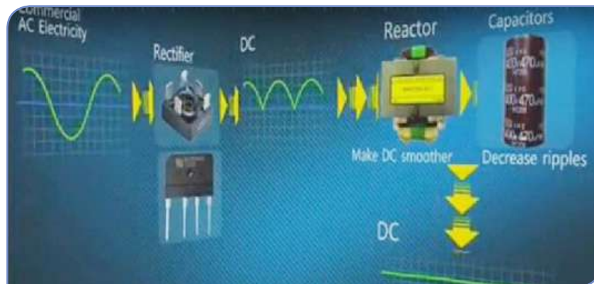
الشكل (2-45): التيار المستمر يصبح أكثر استقرارًا بعد مروره بالمحوّل ثم المكثف.
