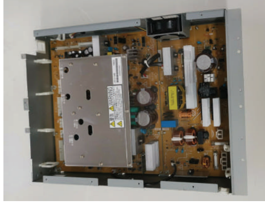
الشكل (34): مكونات دائرة التغذية الكهربائية في آلة تصوير وثائق تماثلية.
