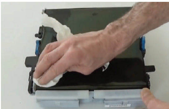
الشكل (10): تنظيف وحدة حزام النقل.
