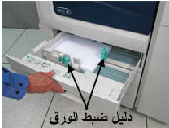
الشكل (25): أدلة ضبط الورق في حافظة الورق في آلة تصوير الوثائق.
