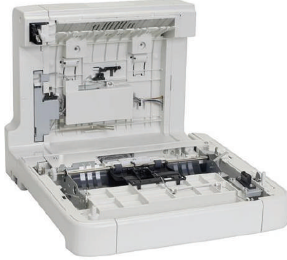
الشكل (10): وصلة قلب الصورة على شكل حرف (L).
