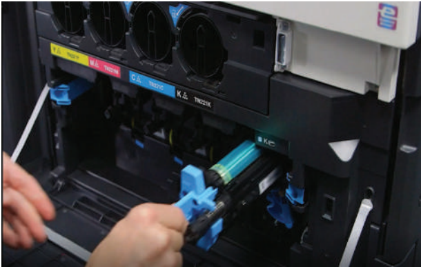
الشكل (19): إعادة تركيب وحدة الأسطوانة الحساسة داخل آلة تصوير الوثائق الرقمية.
