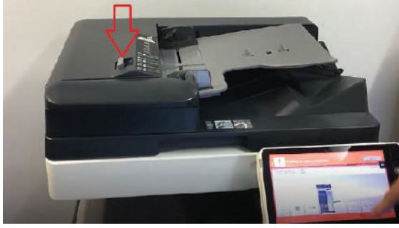
الشكل (10): آلة تبين وجود تحشير في جهاز التلقيم الآلي.
