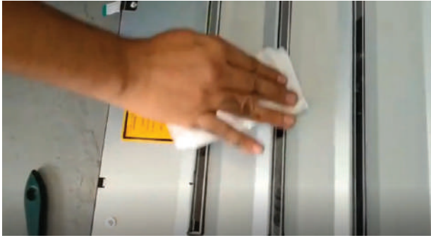
الشكل (14): تنظيف وحدة الكتابة (الليزر).
