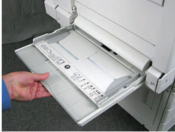
الشكل (26): صينية التغذية (التلقيح) اليدوي.
