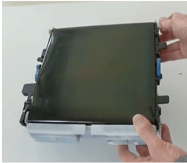
الشكل (9): تفقد وحدة حزام النقل.
