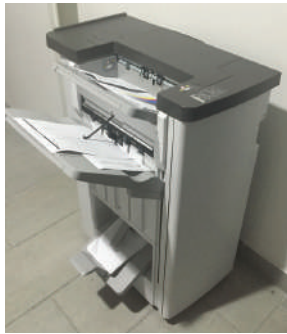
الشكل (19) وحدات الفرز ذات الصواني المتحركة.
