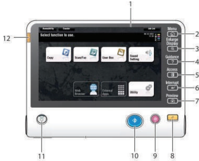
الشكل (4): مكونات لوحة التشغيل والتحكم في آلة تصوير الوثائق الرقمية.
