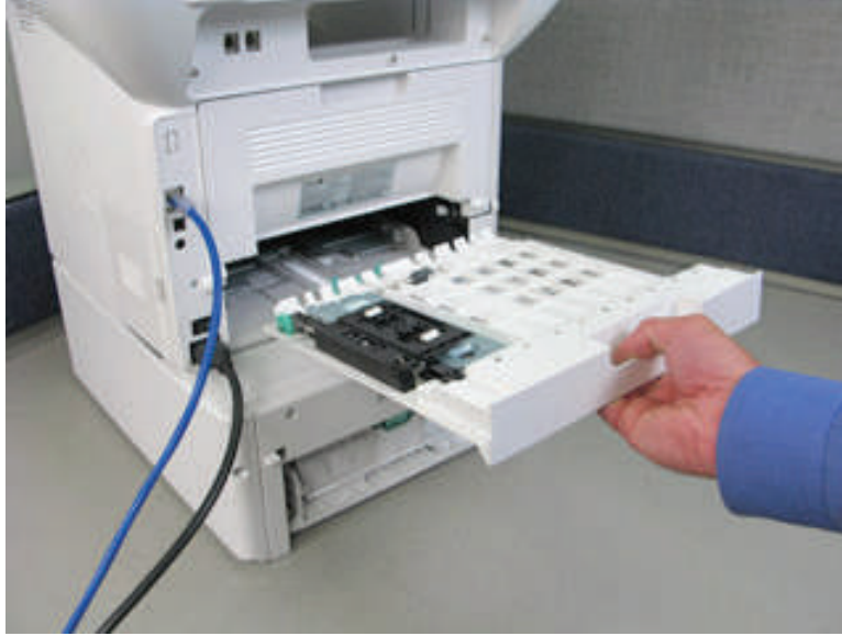
الشكل (8): وحدة قلب الصورة على شكل درج.
