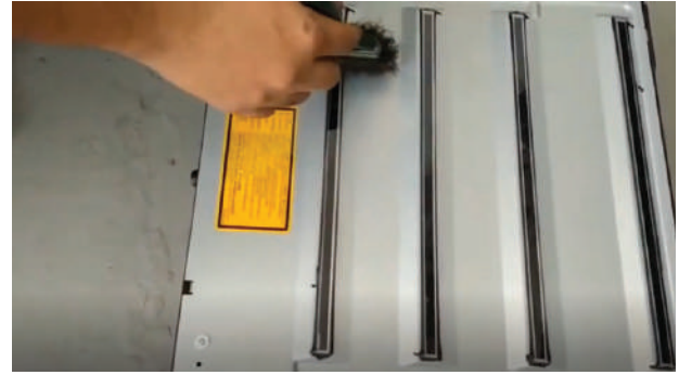
الشكل (14): تنظيف وحدة الكتابة (الليزر).
