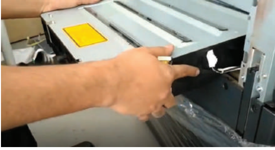
الشكل (13): وحدة الكتابة الليزر المكونة من صندوق.
