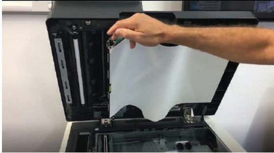
الشكل (11): أزيل الوثيقة من داخل مجموعة استقبال الوثيقة.
