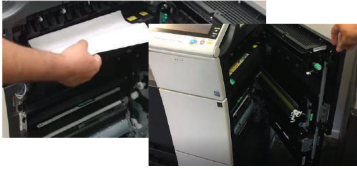
الشكل (6): منطقة عمليات الطباعة في آلة تصوير الوثائق الرقمية.
