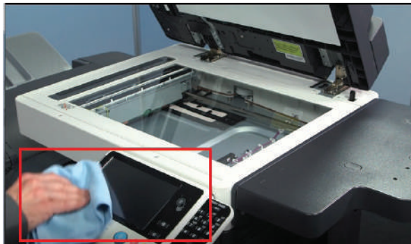
الشكل (5): تنظيف لوحة التحكم.
