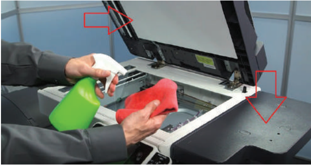
الشكل (7): البطانة البيضاء في جهاز التلقيم الآلي وهيكل الآلة.
