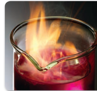
الشكل 9-5 يتفاعل فلز البوتاسيوم بشدة مع الماء مطلقاً كمية كبيرة من الحرارة كافية لإشعال غاز الهيدروجين الناتج واحتراقه.
