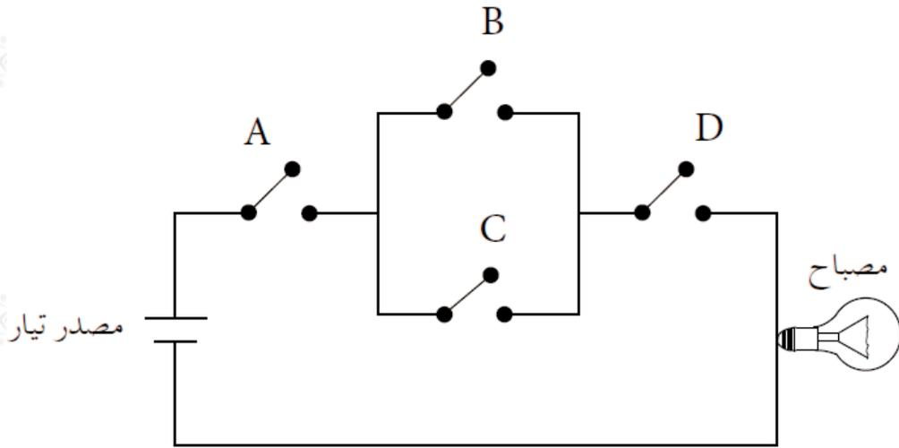
أ- اكتب العبارة المنطقية التي تمثلها الدائرة الكهربائية السابقة.
