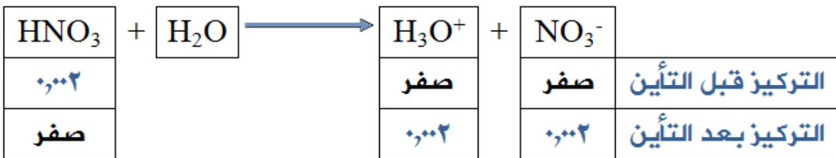
$$[H_3O^+] = [HNO_3] \text{ بعد التأين} = [HNO_3] \text{ قبل التأين} = 2 \times 10^{-3} \text{ مول/لتر}$$
