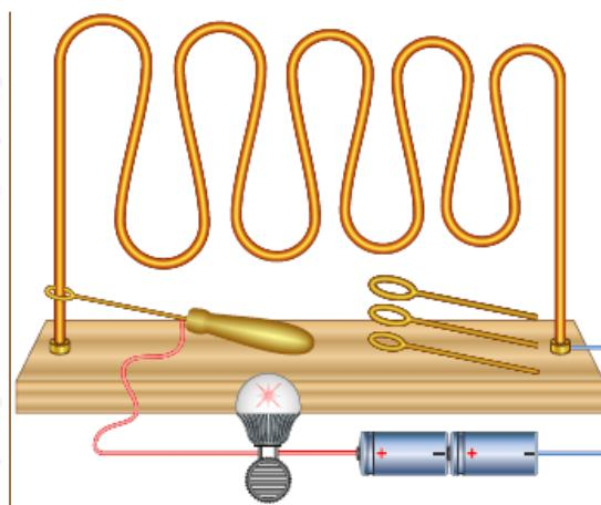
عندما تلامس الحلقة المسار تغلق الدارة الكهربائية بسبب مرور تيار كهربائي ينتج عنه إصدار صوت الجرس، وعند عدم تلامس الحلقة تكون الدارة مفتوحة بسبب عدم إصدار صوت الجرس، الذي يحتاج إلى تيار كهربائي في مسار مغلق ليصدر صوتاً.
