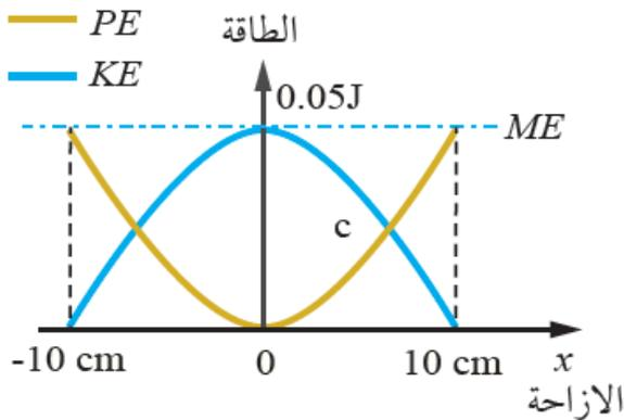
**التفكير الناقد:** يوضِّح الشكل المجاور تغيرات كلٍّ من الطاقة الحركية وطاقة الوضع المرورية، مع الإزاحة لجسم كتلته 400 g يتصل بنابض ويتحرك حركة توافقية بسيطة على سطح أفقي أملس، مستعيناً بالشكل أجيب عما يأتي:
