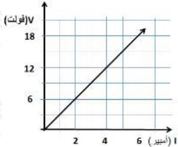
د) أجد مقدار المقاومة الكهربائية مِنَ الرسم.
