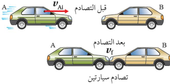
**أحسب:** السيارة (A) كتلتها  $(1.1 \times 10^3 \text{ kg})$  تتحرك بسرعة  $(6.4 \text{ m/s})$  باتجاه المحور  $+x$  ، فتصطدم رأساً برأساً بسيارة ساكنة (B) كتلتها  $(1.2 \times 10^3 \text{ kg})$ ؛ وتلتحم السيارتان معاً بعد التصادم وتتحرك على المسار المستقيم نفسه قبل التصادم، كما هو موضح في الشكل المجاور. أحسب مقدار ما يأتي:
